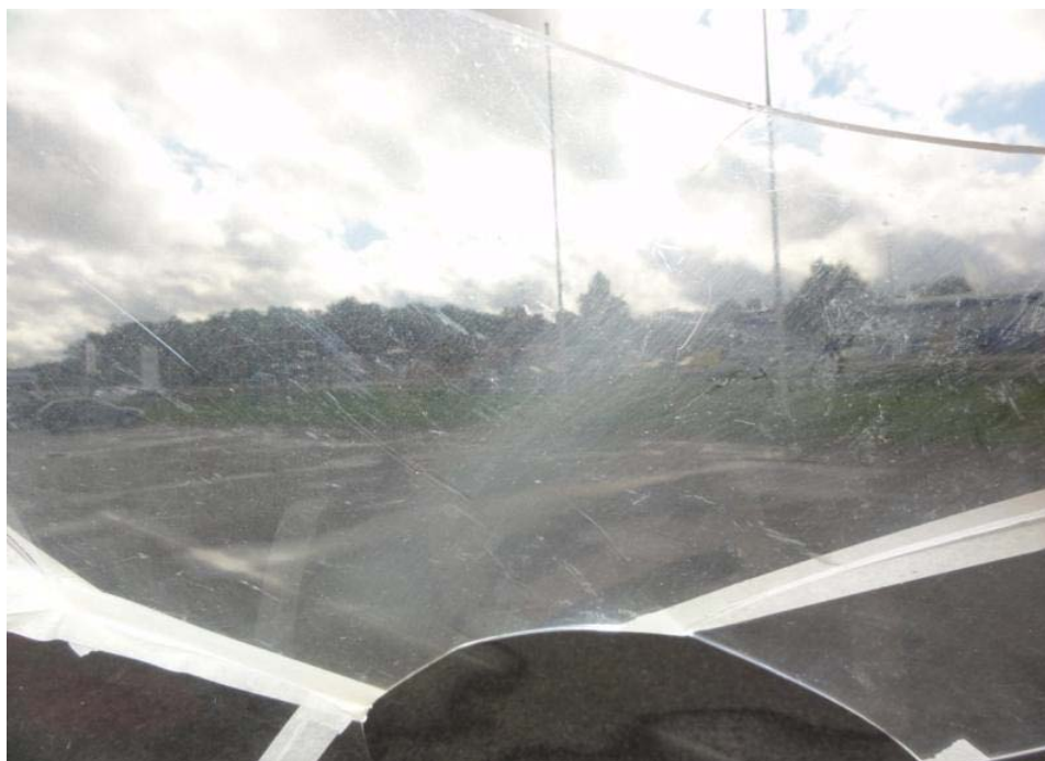
Fig. 3 Sammanfogade delar av frontrutan, foto SHK
